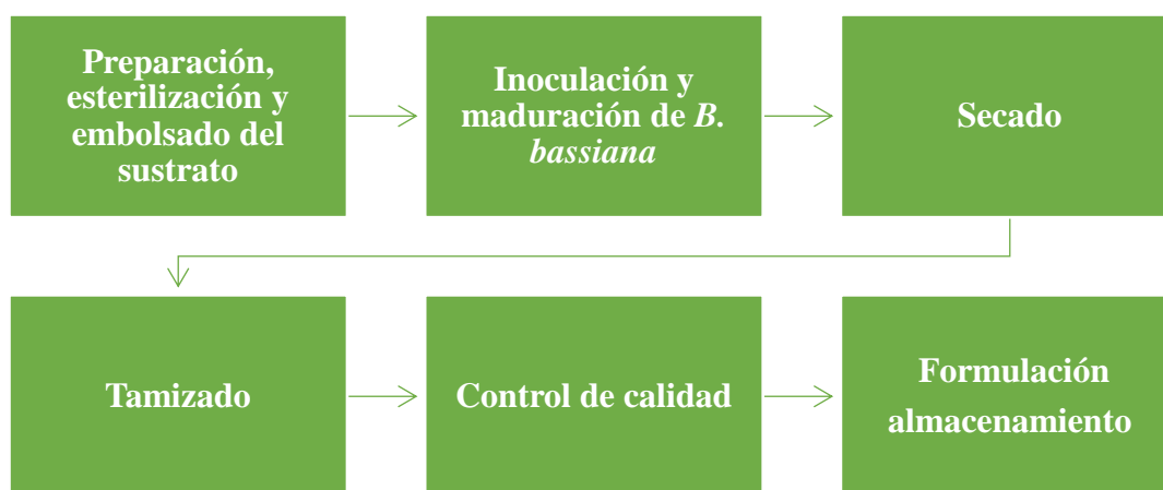
Figura 7. Etapas de producción de B. bassiana en sustrato sólido.
