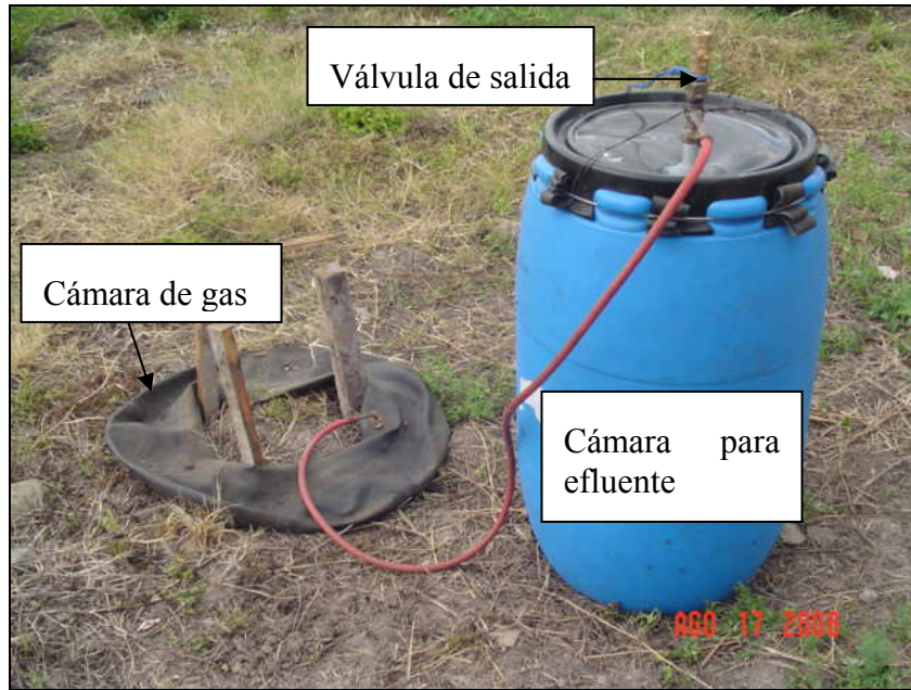
Figura 3. Partes de un biodigestor artesanal (Modelo FAO 1987)
