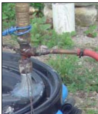
Figura 10. Válvula de salida (Biodigestor artesanal modelo FAO 1987)
