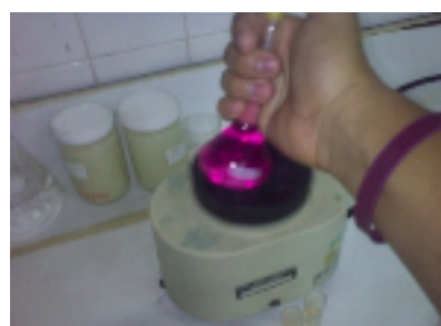
Mezcla de la muestra en el Bortex
