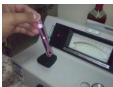
Muestra en cuvette para tomar absorbancia
