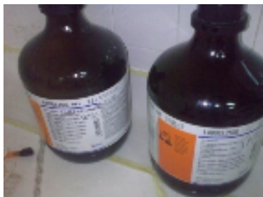
Reactivos Sulfanilamida y NED en botellas oscuras
