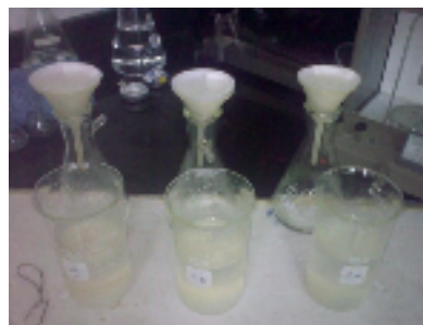
Filtrado de muestras (tiempo aproximado 45 min)
