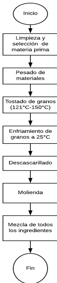
Figura 1. Flujo de proceso de las materias primas para la elaboración del complemento para adultos mayores. Adaptado de Cáceres Rajo (2015).
