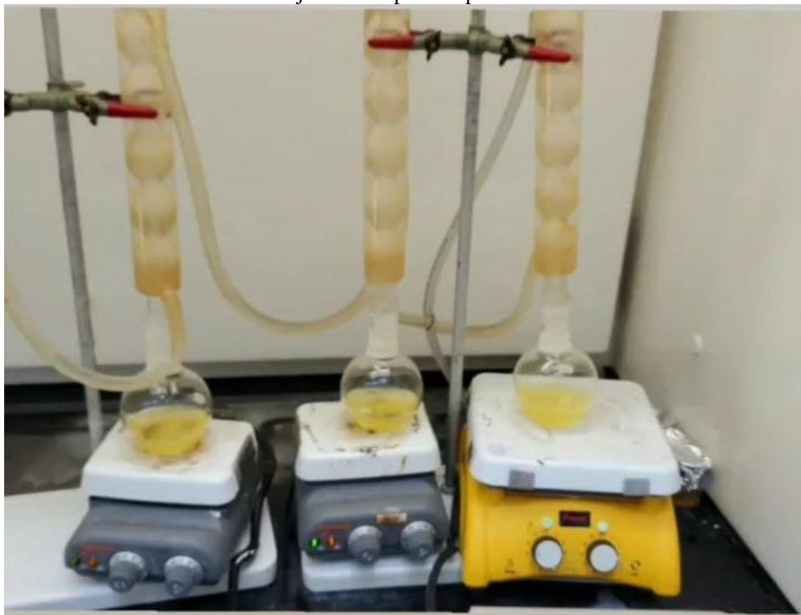
Anexo 6. Condensación de reflujo en la etapa de saponificación del análisis de colesterol.
