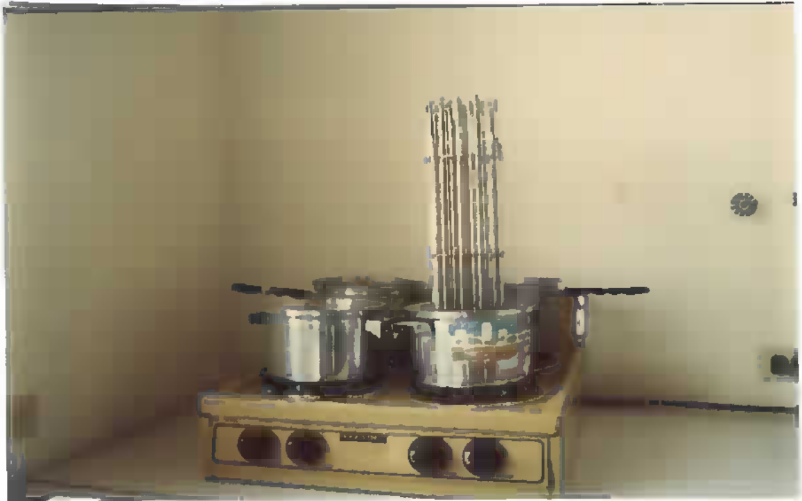
Figura 3. Pruebas de cocción con el cocedor Mattson. Las ollas se mantuvieron con agua hirviendo sobre una estufa de gas y el cocedor Mattson aparece dentro de una de ellas.
