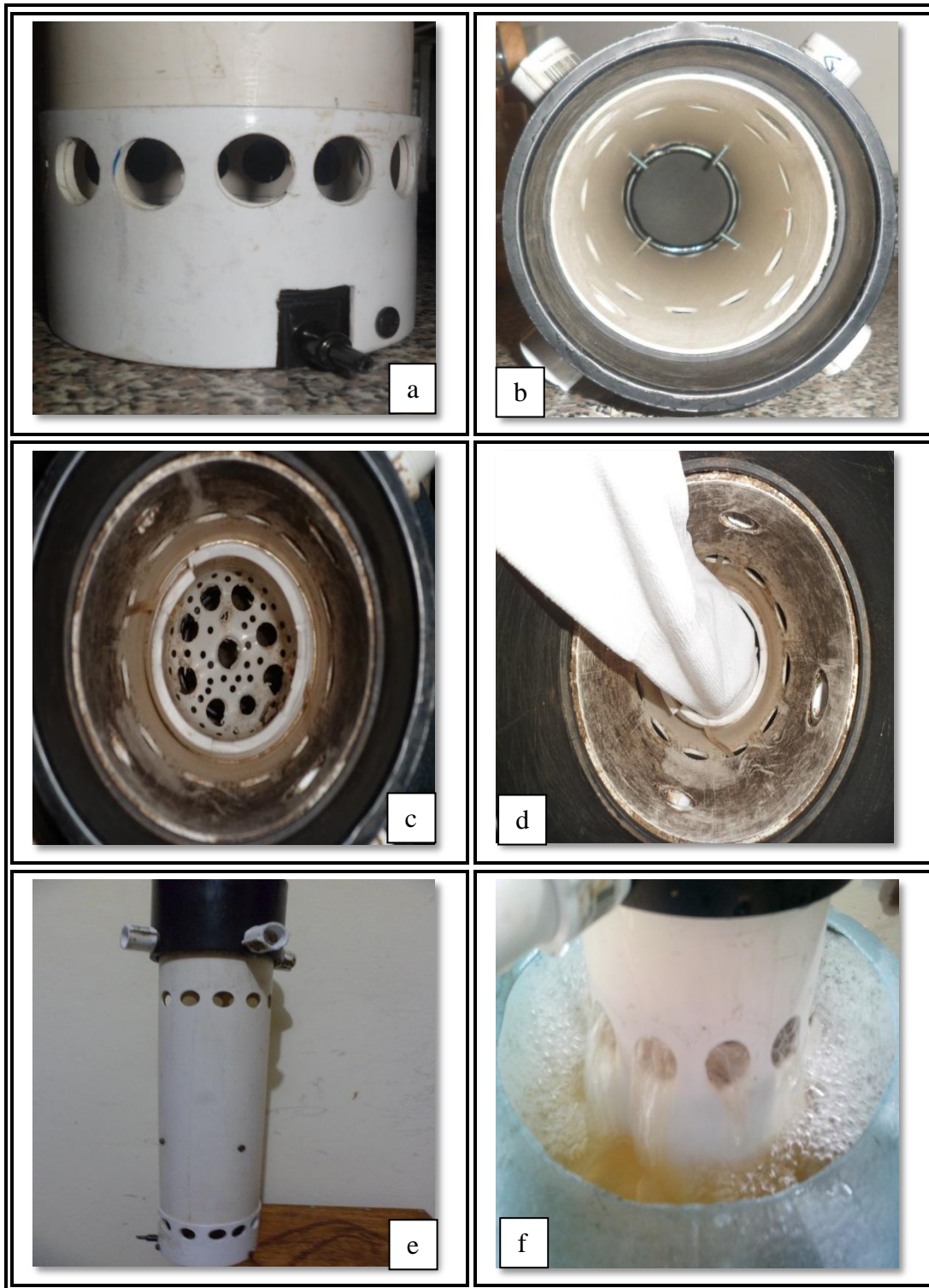
Figura 2. Funcionamiento y partes del tubo central (PVC): (a) Salida difusor de aire y huecos de recirculación; (b) Tubo central visto desde arriba; (c) Contenedor vacío dentro del tubo central; (d) Contenedor con media nylon y compost dentro del tubo central; (e) Tubo central completo; (f) Recirculación del té a través del tubo central.
