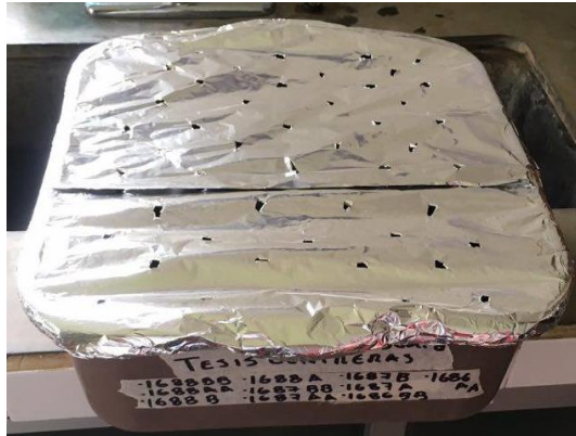
Figura 3. Bandeja con papel aluminio con suelos incubados a 24 °C para determinar mineralización de carbono y nutrientes, Laboratorio de Suelos Zamorano.
