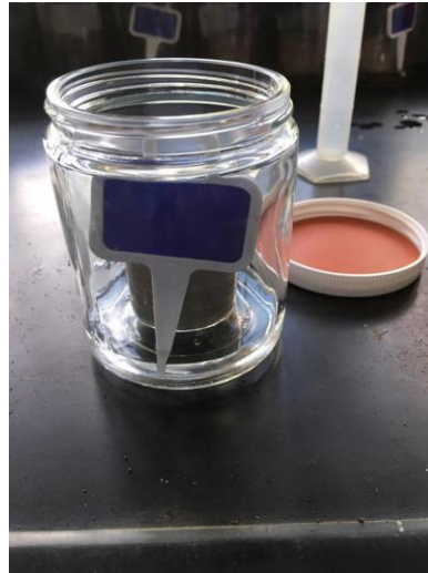
Figura 4. Frasco de prueba de emisiones de CO 2 para determinar la actividad microbiana en los suelos (Prueba Solvita®)
