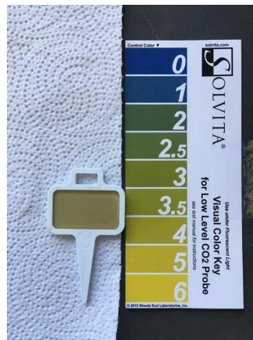
Figura 5. Comparación de sonda y tabla de color para la determinación de emisiones de CO 2 de las muestras de suelo después de 24 horas de incubación (Prueba Solvita®).
