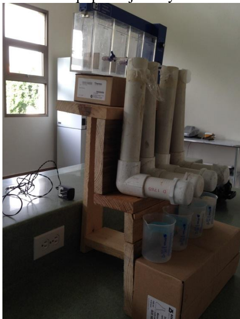
Anexo 2. Equipo de jarras y filtros de arena utilizados en el estudio.
