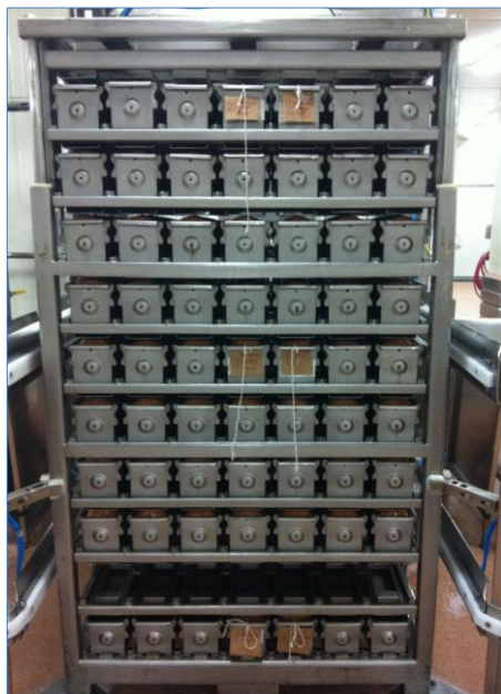
Figura 1. Posición de los sensores térmicos dentro de la torreprensa.
