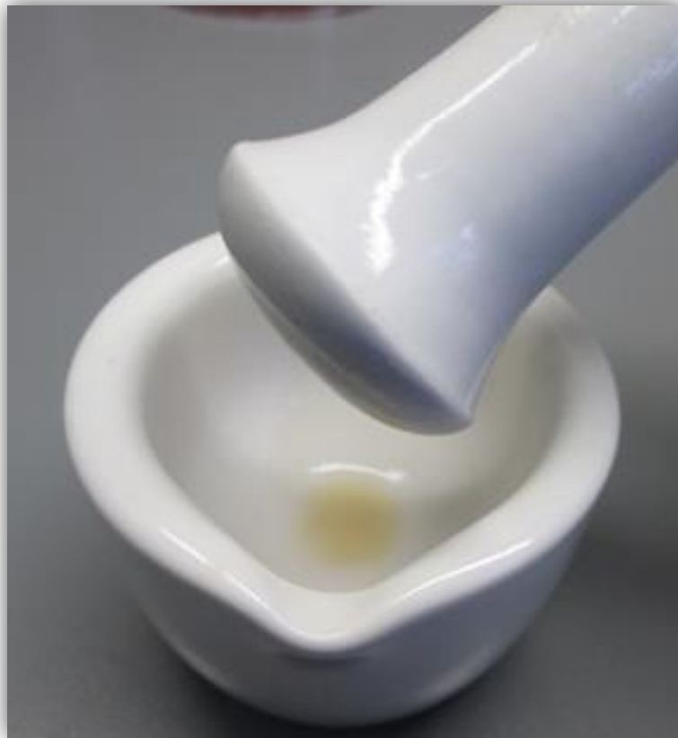
Figura 1. Maceración de nematodos entomopatógenos, usando mortero y pistilo.
