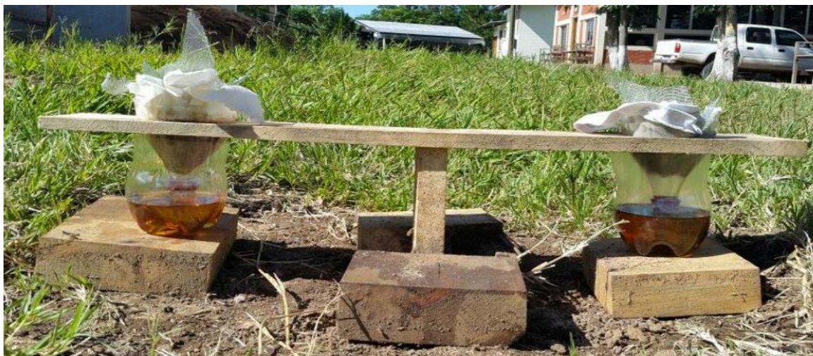
Figura 4. Sistemas por gravedad (izquierda filtros de papel y a la derecha filtros de tela).
