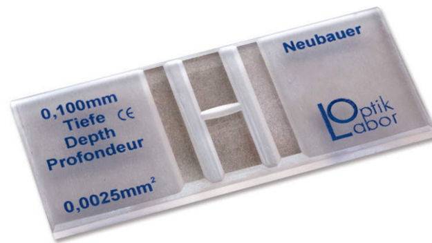
Figura 1. Cámara de Neubauer para el conteo de células espermáticas (Córdova Izquierdo 2020).
