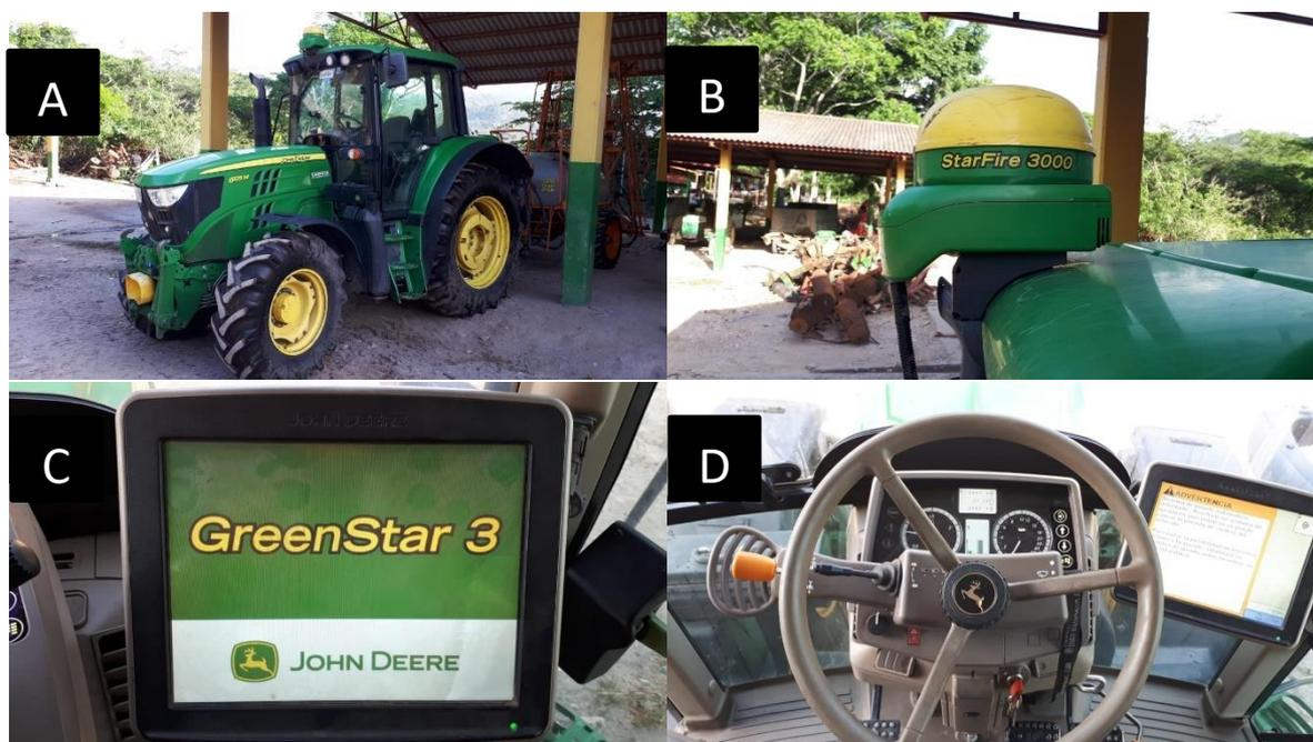
Nota. Tractor John Deere® 6125M (A), receptor de señal StarFire 3000 (B), monitor GreeStar 2630 (C), piloto automático AutoTrac™ (D).
