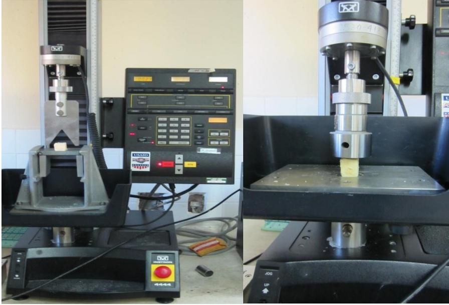
Anexo 6. Análisis de corte y compresión de queso con texturómetro Instron 4444.
