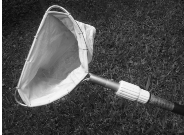
Figura 3. Trampa D utilizada para recolectar macro-invertebrados acuáticos.
