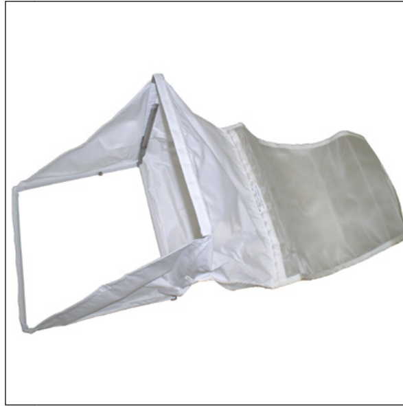
Figura 1. Red Surber utilizada para recolectar macro-invertebrados acuáticos. Fuente: Beltec, 2006.
