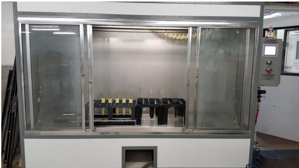
Figura 2. Cámara de pulverización de pista de aplicación automática con velocidad y presión modificables (Generation III Research Track Sprayer DeVries Manufacturing, Hollandale, Minnesota 56045).
