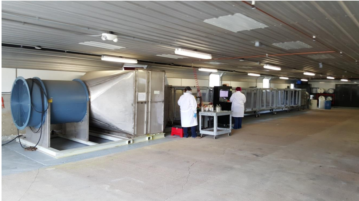
Figura 1. Túnel de viento de baja velocidad con secciones de 1.2 \times 1.2 m y sistema de difracción laser para diferenciar el tamaño de gota, propiedad del PAT Lab en la Universidad de Nebraska Lincoln, Nebraska, Estados Unidos.
