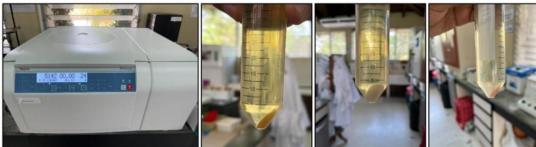
*Nota.* Centrifugación de los tubos de Falcon a 1000 rpm por 10min para obtención de pellets bacterianos
