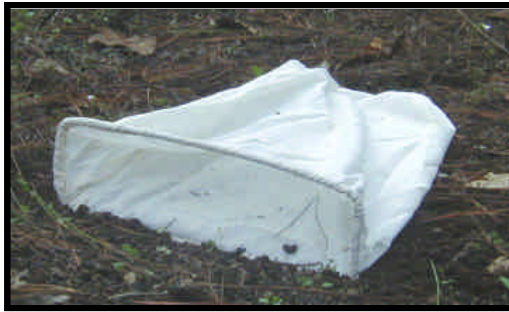
Figura 2. Bolsas utilizadas para estimar la tasa de erosión.
