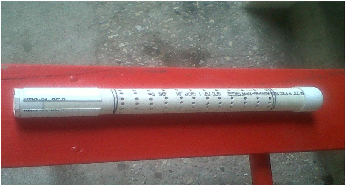
Figura 1. Sonda de lixiviación elaborada por el autor.
