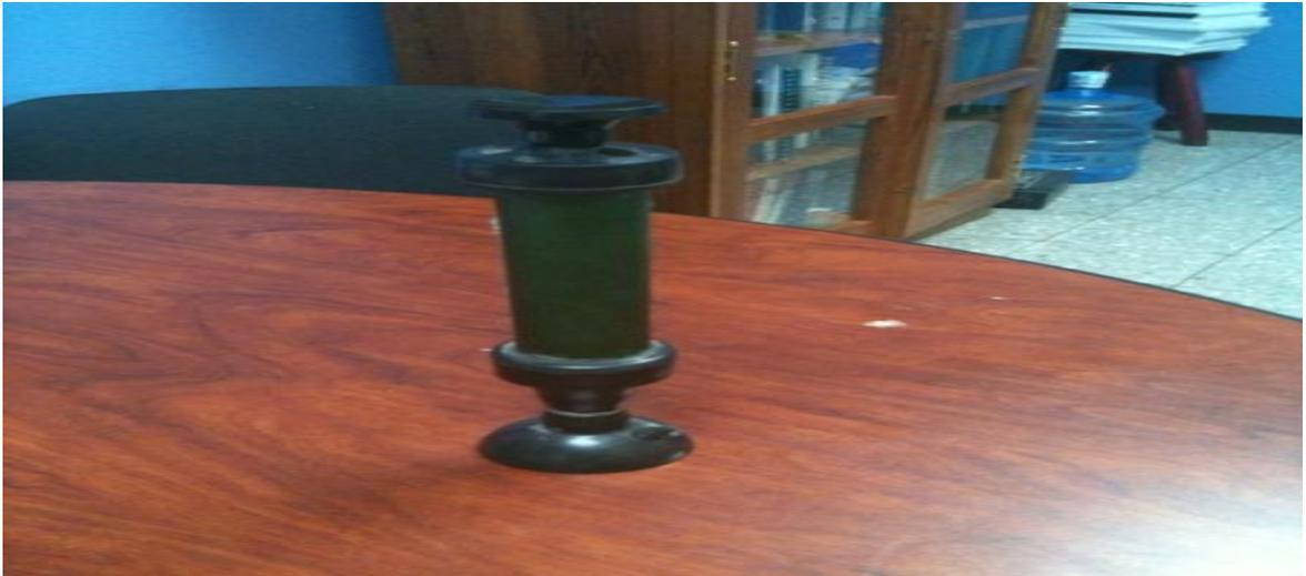
Anexo 8. Bomba de succión manual utilizada en el estudio elaborado por Irrometer Co.
