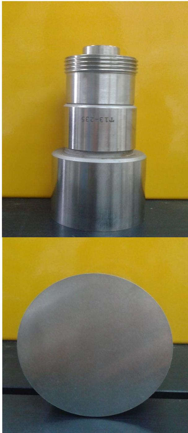
Anexo 5. Acople de Compresión Crosshead Speed Yunque 57mm O (Instron 4444).
