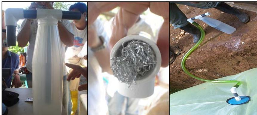
Figura 8. Válvula de seguridad
