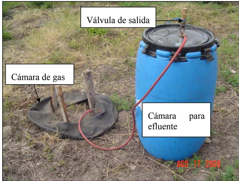
Figura 3. Partes de un biodigestor artesanal (Modelo FAO 1987)
