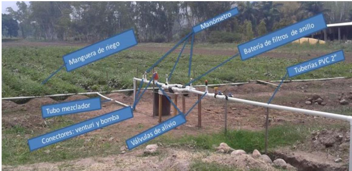
Figura 1. Componentes del sistema de fertiriego.
