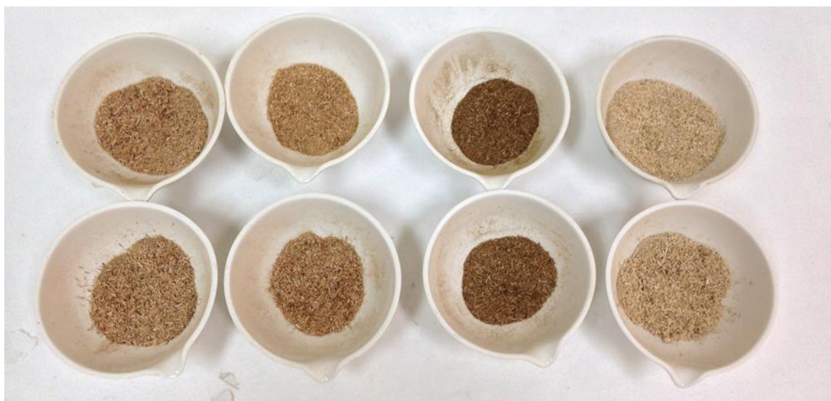
Anexo 15. Bagazo seco de caña de azúcar después del pretratamiento ácido diluido. Arriba los tratamientos a 150°C, abajo a 120°C. De izquierda a derecha 3%, 6%, 12% y 0% de H 2 SO 4 .
