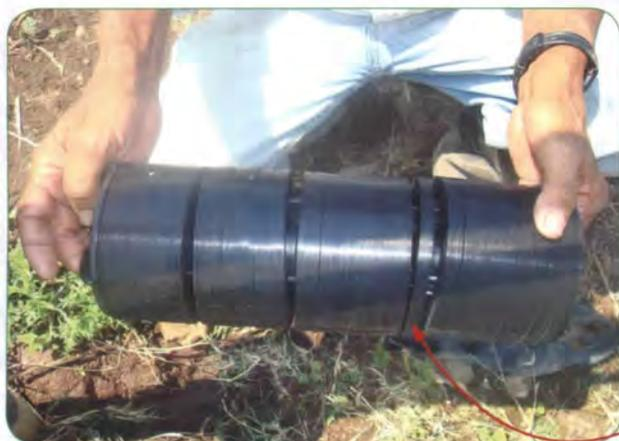
Foto 47. Anillos que atrapan el sucio del agua de riego.
