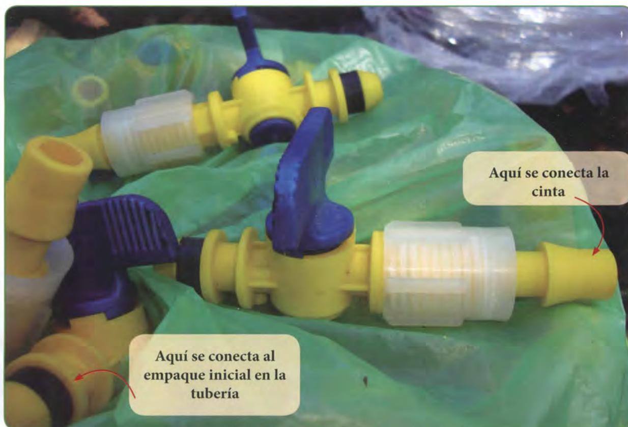
Foto 60. Conector inicial de PVC a cinta de riego con válvula.
