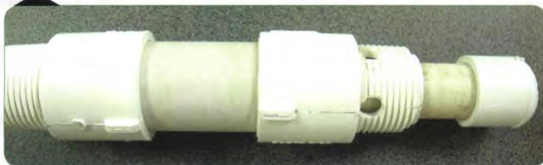
Una vez armada la válvula, puede ser instalada en una T que tenga un adaptador hembra, solo se enrosca el extremo del adaptador macho colocando un poco de teflón en la rosca y está lista para su funcionamiento.
