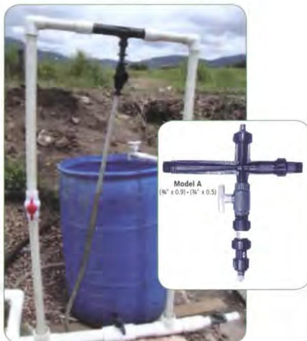
Foto 30. Inyector venturí de fertilizante
