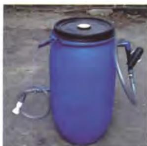
Foto 31. Tanque o barril de fertilización.
