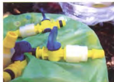
**Foto 60.** Conector inicial de PVC a cinta de riego con válvula.
