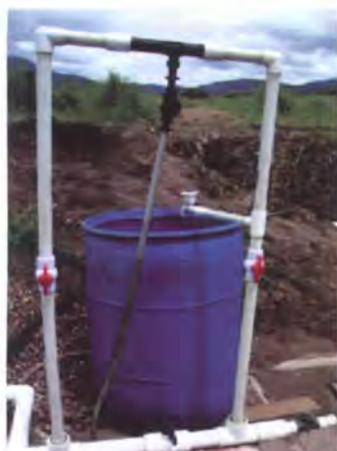
Foto 30. Inyector de fertilizante Venturi.
