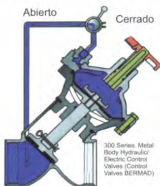
**Fig. 24.** Válvula hidráulica, puede ser manual o de mando eléctrico.
