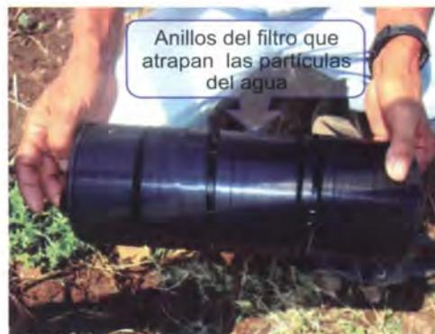
Foto 49. Anillos que atrapan el sucio del agua de riego.
