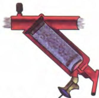
Fig. 26. Filtro de malla instalado.
