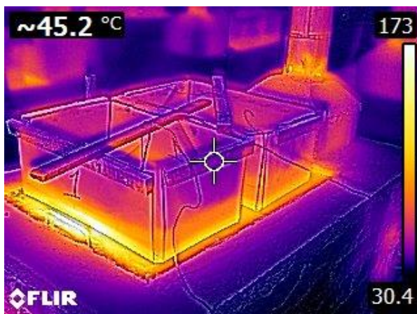
Distribución del calor en la estufa Justa 3D CL CO en tercera fase del WBT
