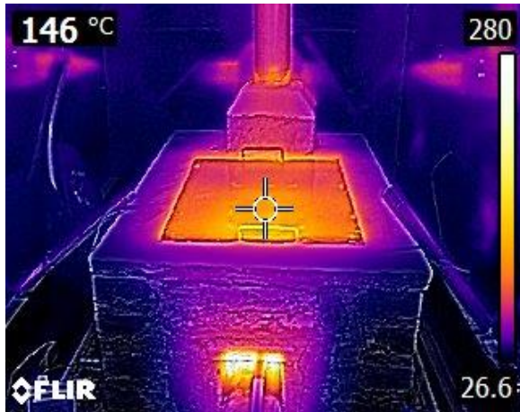
Monitoreo de la distribución del calor de la estufa Justa 16x24 CO en la tercera fase del WBT.
