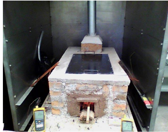
Monitoreo de la distribución del calor de la estufa Justa 16x24 CO en la tercera fase del WBT.
