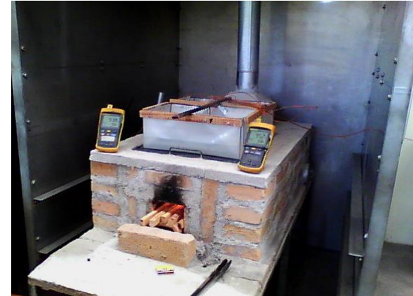
Monitoreo de la distribución del calor en la Estufa Justa 3D CL CO
