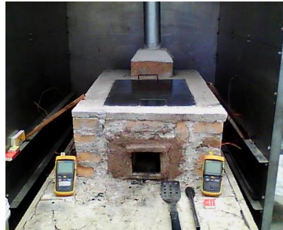
Monitoreo de la distribución del calor de la estufa Justa 16x24 CO en la tercera fase del WBT.
