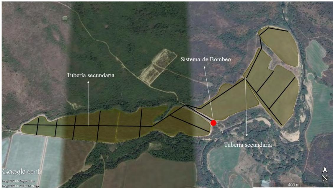
32.4. Diagrama de tuberías del sistema de riego utilizado en la Finca Los Llanos.
