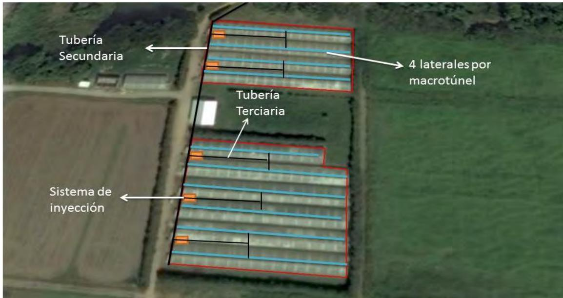
23.3. Diagrama de la tubería principal y las ramificaciones que salen de esta hacia los macro túneles. Los inyectoros o Venturi están de color naranja y cada macro túnel tiene cuatro laterales los cuales cada lateral supe a dos hileras de cultivos.
