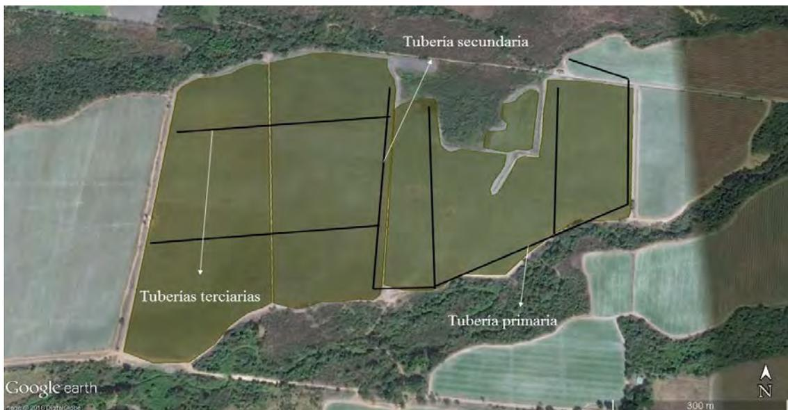
31.4. Diagrama de tuberías del sistema de riego utilizado en Florencia I.
