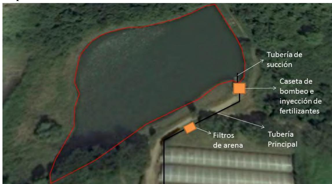
23.2. Mapa aéreo de la primera parte del sistema que incluye localización del sistema de bombeo, filtrado y tubería de distribución.
