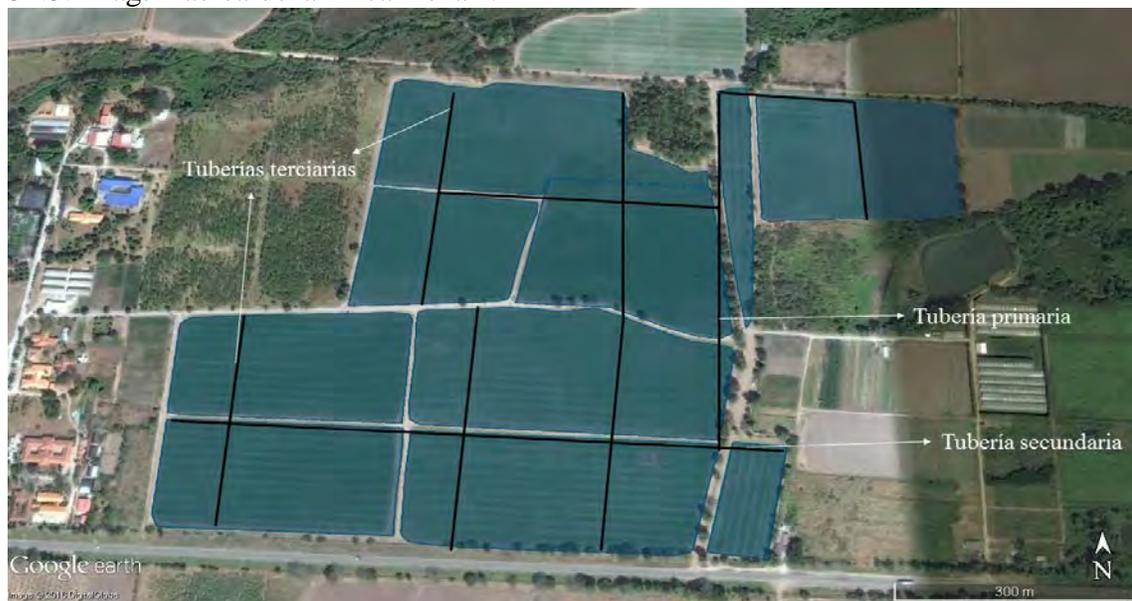
34.4. Diagrama del sistema de riego utilizado en la Finca Zona I.
