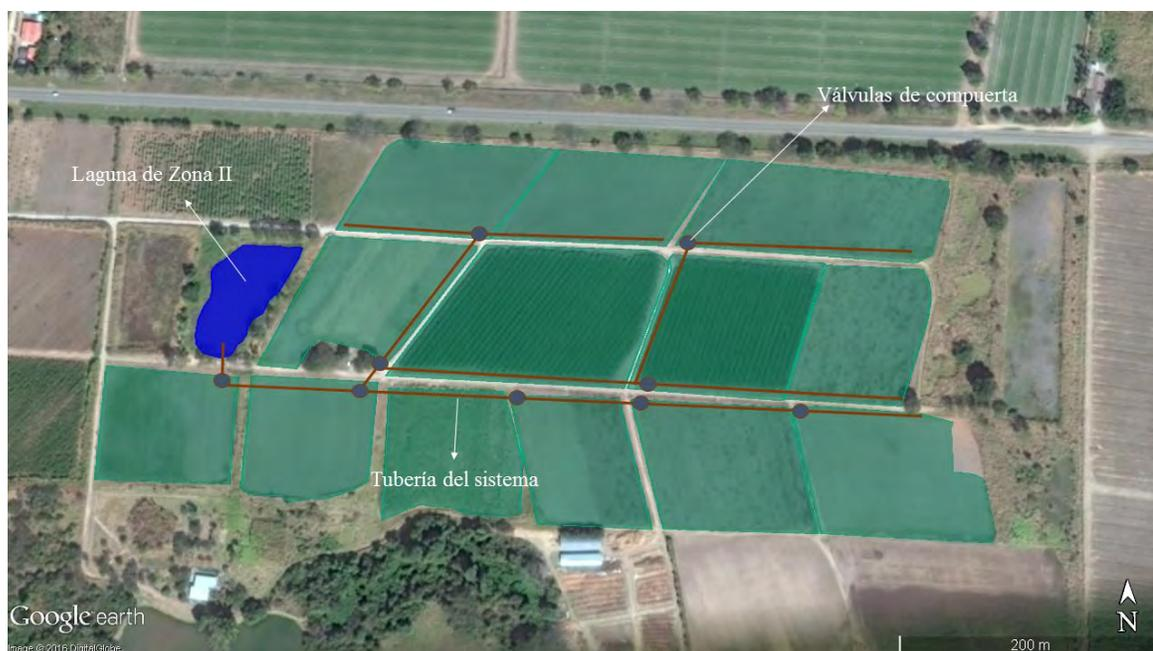
29.4. Diagrama del sistema de riego utilizado en Zona II.
