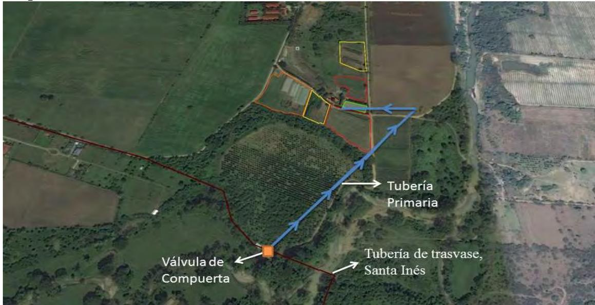
20.3. Ubicación del lote, tubería principal y válvula principal del sistema de riego utilizado en MIC – CC.
