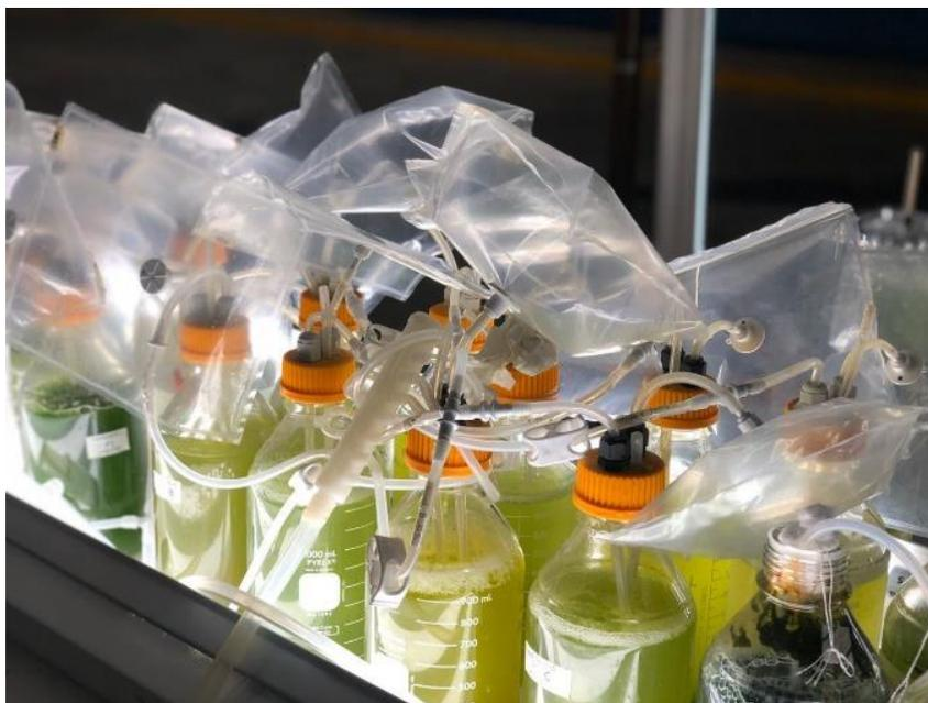
Figura 2. Toma de muestra de gas en la salida de los sistemas.
