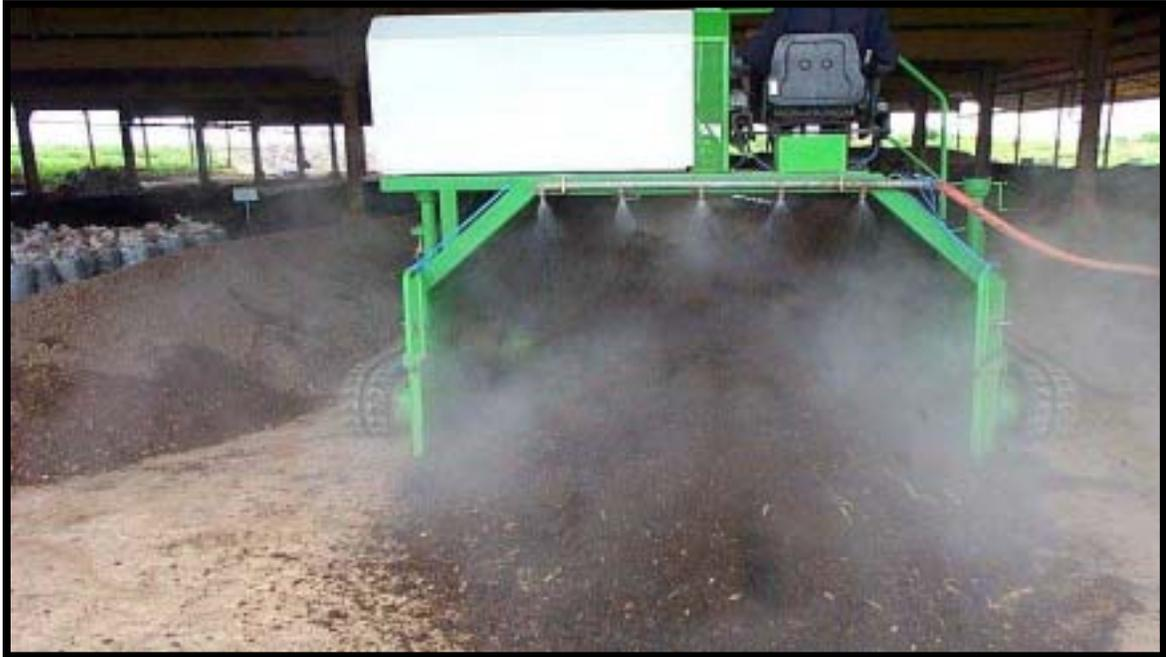
**Figura 9.** Volteadora de compost autopropulsada (Industrial Baby) de la compañía Autrusa, con implementos acondicionados para adicionar humedad si es necesario. Standard Fruit de Honduras S.A. 2002.
