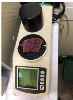
Figura 2. Colorímetro Hunter Lab utilizado para el análisis de color.
