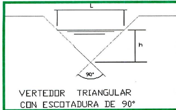
Hay diferentes clases de vertedores según la forma en que se obligue a adoptar a la sección de la vena líquida que circula por la escotadura, de modo que puede ser rectangular, trapezoidal, triangular o circular.
