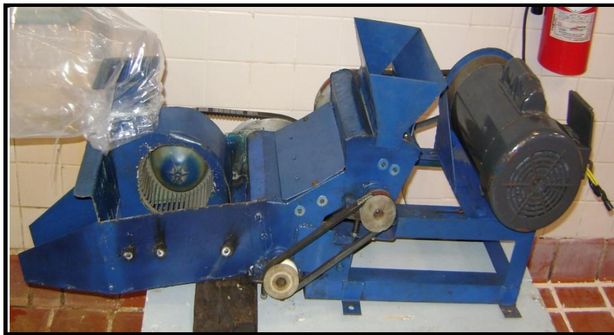
Figura 6. Máquina con el soplador integrado
