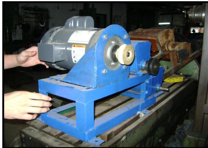
Figura 4. Motor y poleas ubicadas en la máquina
