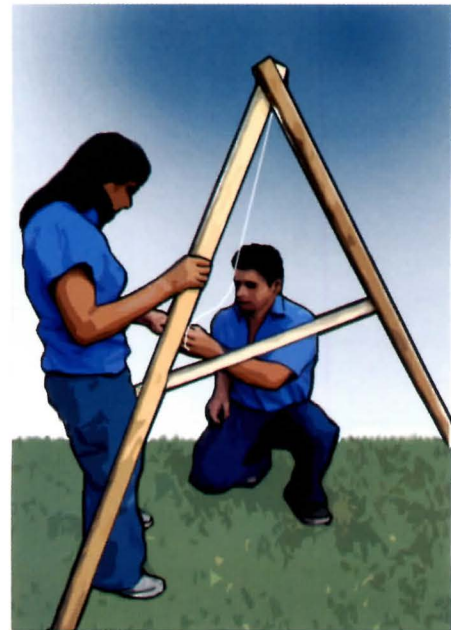
Fig. 30. Construcción del nivel "A".
