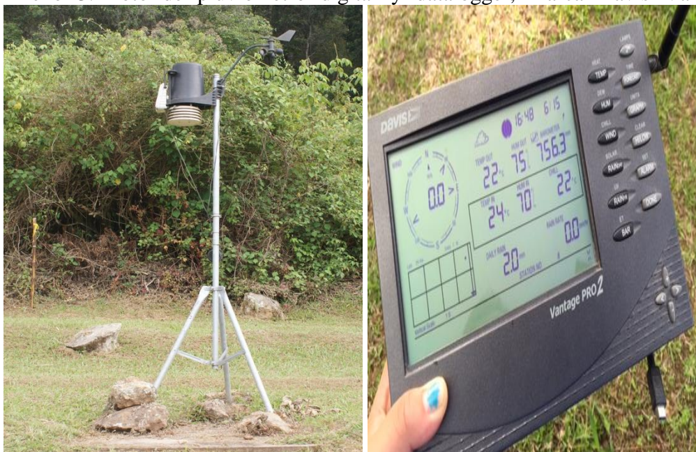
Anexo 3. Foto de pluviómetro digital y datalogger, marca Davis Vantage Pro 2.
