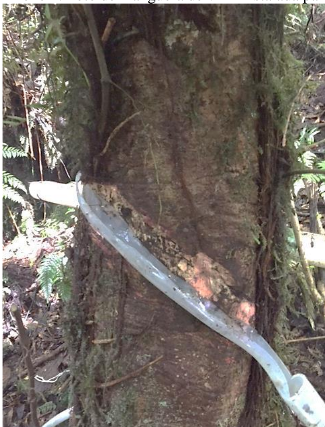
Anexo 2. Foto de manguera de vinil instalada para medir el escurrimiento de tronco.
