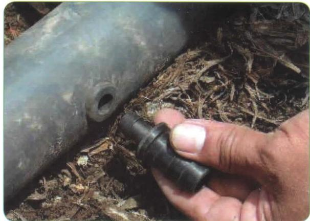
Foto 91. Conector Inicial de tubo a polietileno.
