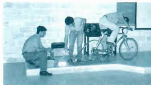
El grupo permanente de apoyo también contribuyó en la elaboración de tecnología apropiada para ser utilizada en las comunidades; en este caso se ve una bicicleta generadora de energía eléctrica para uso doméstico.
