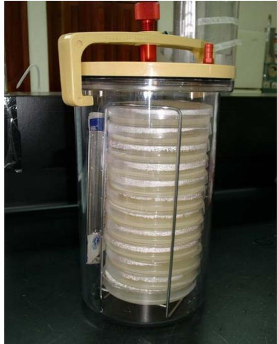
Cámara para crear condiciones anaeróbicas.
