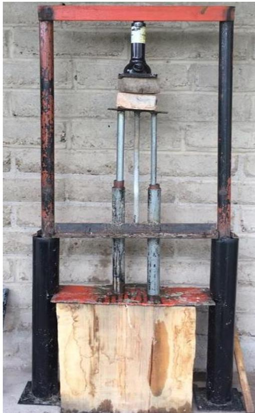
Figura 3. Briqueteadora construida con materiales reciclados.
