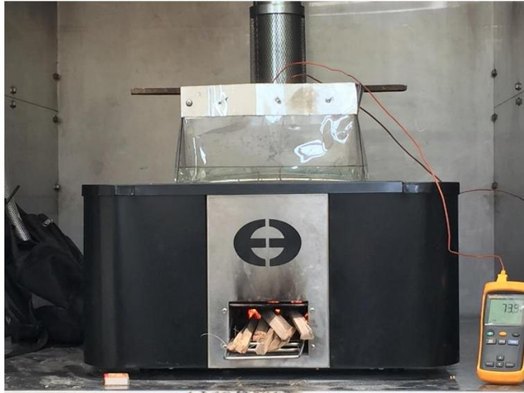
**Anexo 4.** Briquetas de aserrín en la cámara de combustión de la estufa HM-4000.
