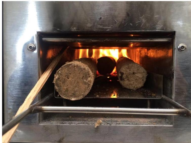
**Anexo 5.** Briquetas de bagazo en la cámara de combustión de la estufa HM-4000.
