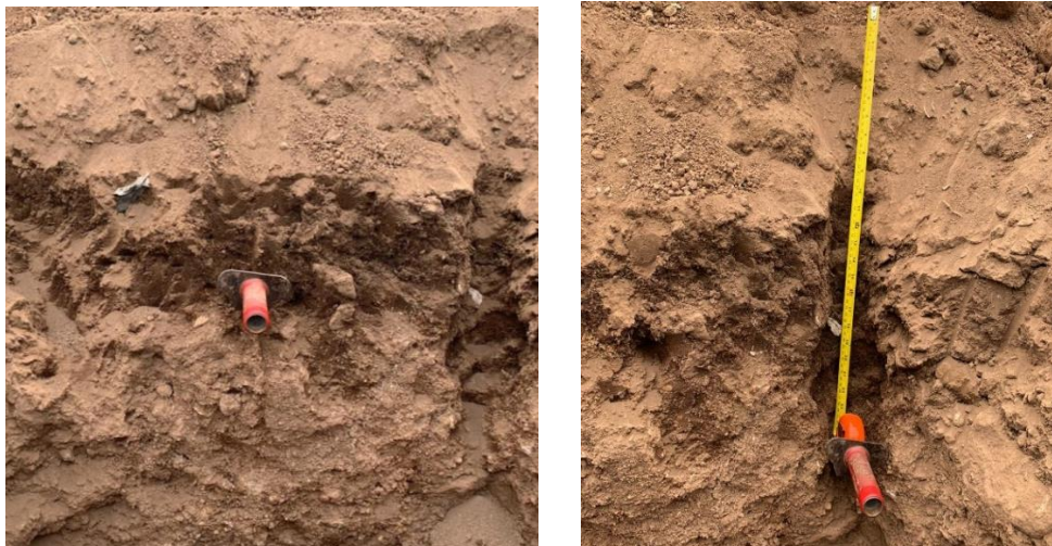
Figura 2. Descripción de la profundidad del subsoleo y el efecto en el suelo, en el área no pedregosa (lote #2), de la Zona San Nicolás de la Escuela Agrícola Panamericana, Zamorano, Honduras.
