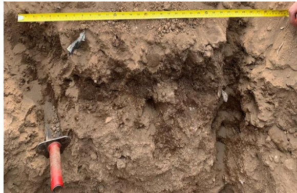
Figura 1. Descripción del ancho del subsoleo en el suelo mediante el distanciamiento de sus cinceles traslapados, en el área no pedregosa (lote #2), de la Zona San Nicolás de la Escuela Agrícola Panamericana, Zamorano, Honduras.
