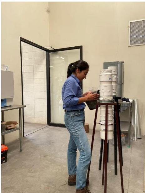
Los materiales fueron ubicados de abajo hacia arriba, en el que una vez llenado una capa se le tapó con la malla de tela en las roscas para después seguir con la siguiente capa. Al momento de terminar de cubrir una capa se media con una regla cuantos centímetros había ocupado de ese sustrato. Esto con el fin de medir la altura que ocupa un sustrato en una capa del filtro.
