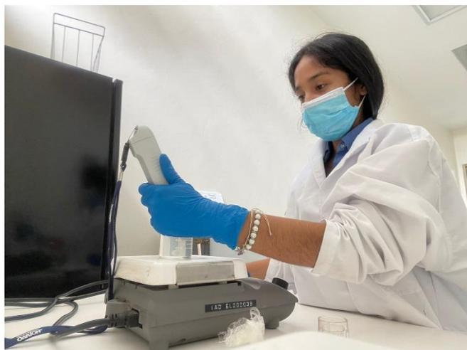
Para la toma de muestras se colocaba el agua en un “beaker” de cristal, para luego colocarle una capsula magnética en un agitador magnético.
