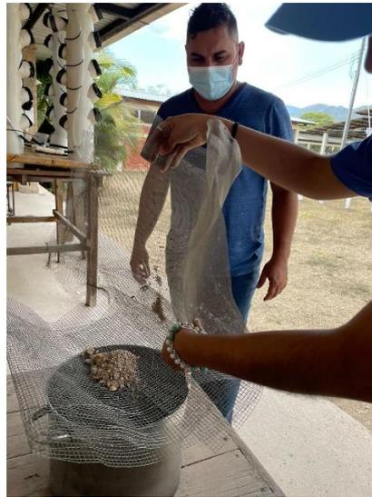
El tamizado se lo hizo por medio de redes metálicas, donde se separó mediante el tamaño de partícula de los sustratos. Se inicio separando la grava, en el cual caían dentro de una olla de metal la arena gruesa y la arena fina. Posteriormente, se separó la arena gruesa de la fina con una red más pequeña. Estos materiales fueron lavados después de este proceso.
