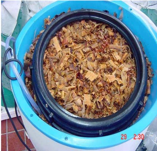
Tina de viruta con tubería de cristal (plástico) donde ingresa aire fresco al sistema.
