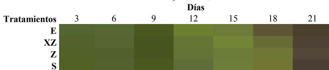
E: Empaque sin zeolita. XZ: Empaque con concentración de 2% de zeolita. Z: Empaque con concentración de 1.5% de zeolita. S: Fruto sin empaque.
