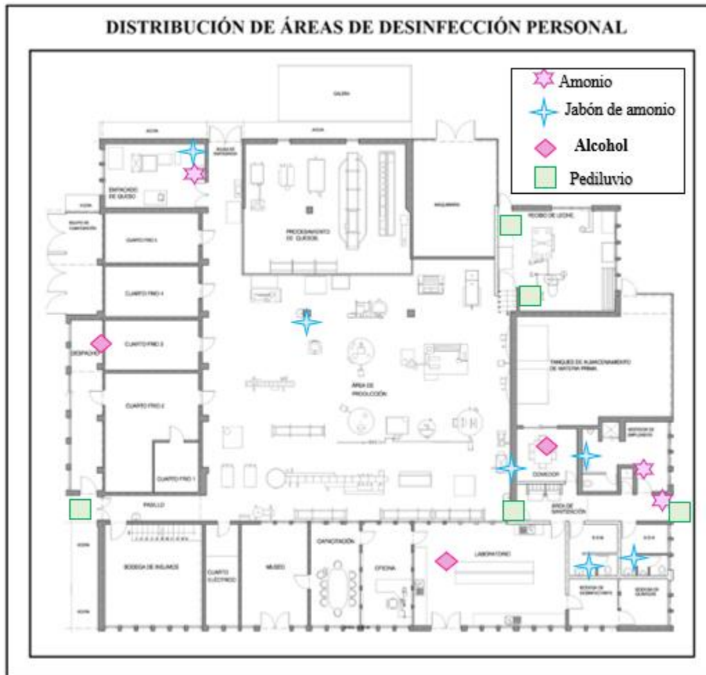
Figura 5. Distribución de áreas de desinfección personal
