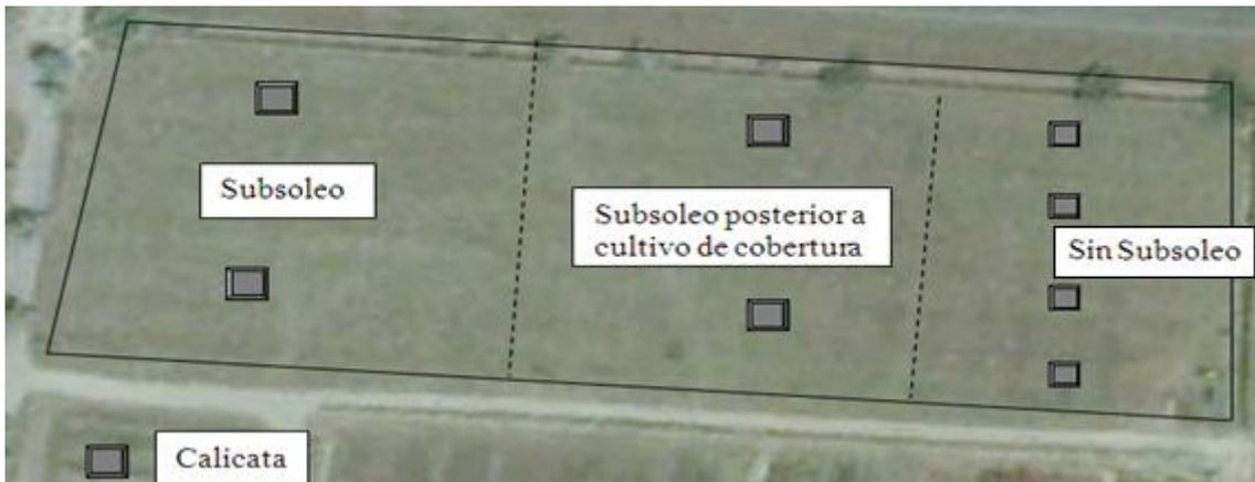
Figura 2. Distribución de calicatas en el área antes y después del subsoleo. Lote 0, sección de Olericultura. E.A.P. Zamorano, Honduras.
