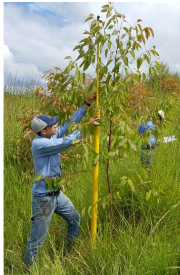
Figura 8. Medición de altura total del árbol con ayuda de vara de maniobra telescópica.
