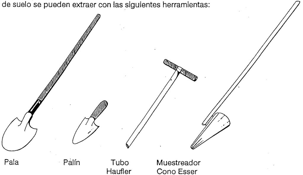
Las muestras se deben tomar de manera que el suelo extraído salga como una franja entera, de dos a cinco centímetros de ancho por 15 a 40 centímetros de profundidad. El muestreador Cono Esser y el Tubo Haufler extraen franjas exactas del ancho y largo. La pala y el pálm pueden sacar demasiado suelo a lo ancho, y es necesario eliminar el exceso con la mano o un cuchillo para que queden las medidas mencionadas.
