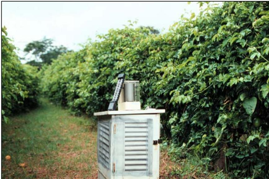
Figura 2. Higrotermógrafo usado para la toma de datos de humedad relativa y temperatura en las plantaciones evaluadas en Olancho
