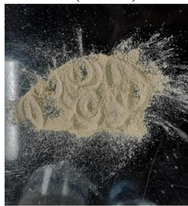
Figura 1. Proceso de obtención de polvo de cáscara de huevo con granulometría 0.5 mm.
