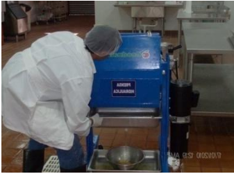
Figura 4. Estudiante poniendo en marcha la presa hidráulica.
